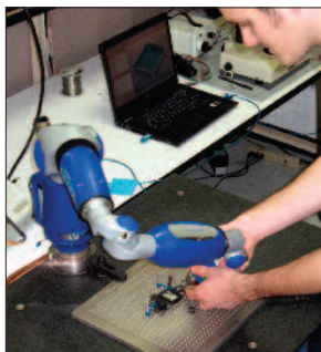
El uso integrado de los equipos móviles de medición permite mejorar la exactitud de medición durante el proceso de fabricación de parte.
